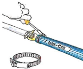
Per intercettare il gas è consigliabile installare un rubinetto, interno o esterno, che consenta il controllo visivo della chiusura. A tale scopo sono utili anche i rubinetti posti sulla bombola o sul contatore. È buona regola chiudere tale rubinetto ogni volta che si esce di casa.
